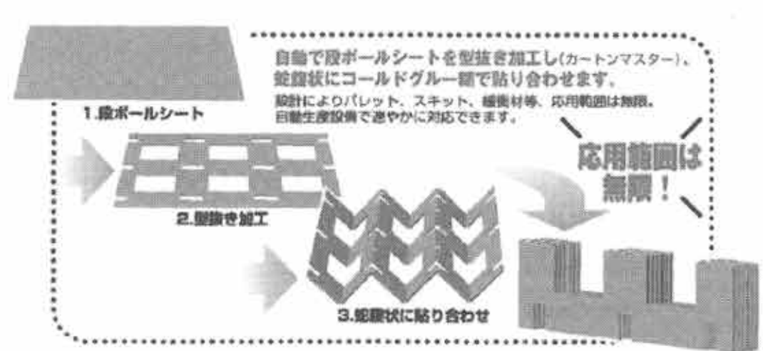
図1 CFG の基本生産工程
